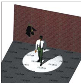
Personenlicht mit falsch eingerichtetem Scheinwerfer
