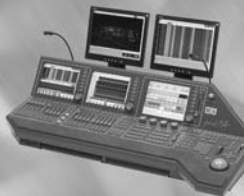
Lichtstell- und Effektpult grandMA
