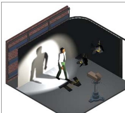
Aufhell-Licht über Stufenlinsenscheinwerfer (linkes Gerät)
